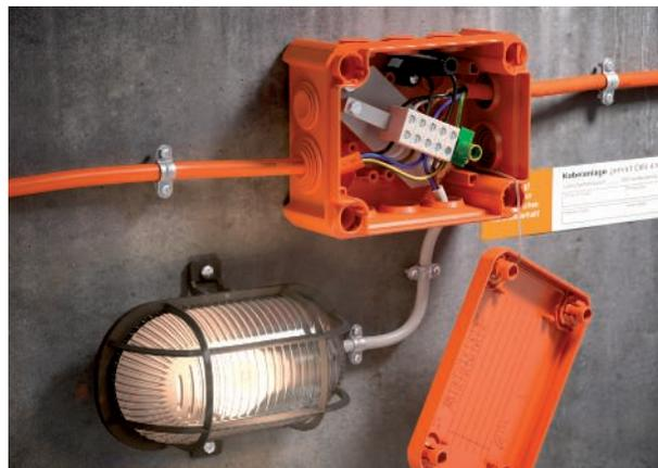
Kabelabzweckkästen mit integriertem Funktionserhalt sorgen für die brandsichere Verbindung der Sicherheitskabel. Die Kästen der FireBox-Serie sind für 30 bis 90 Minuten Funktionserhalt nach DIN 4102-12 geprüft und zugelassen.
